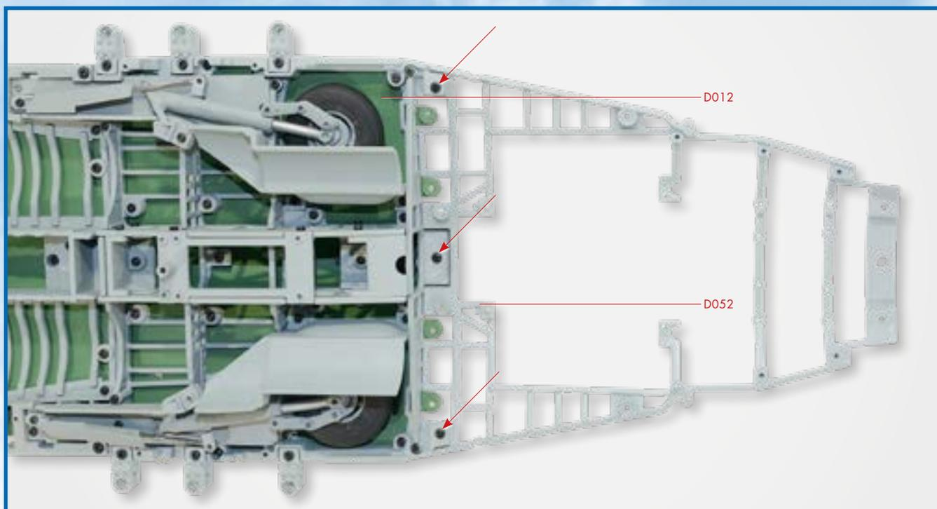
**2** Затем аккуратно состыкуйте раму (D052) с силовым набором средней секции фюзеляжа. Это удобнее сделать, если положить собранный блок модели обшивкой вверх. Зафиксируйте раму винтами LM, как показано на снимке. Очередной этап сборки завершен.
