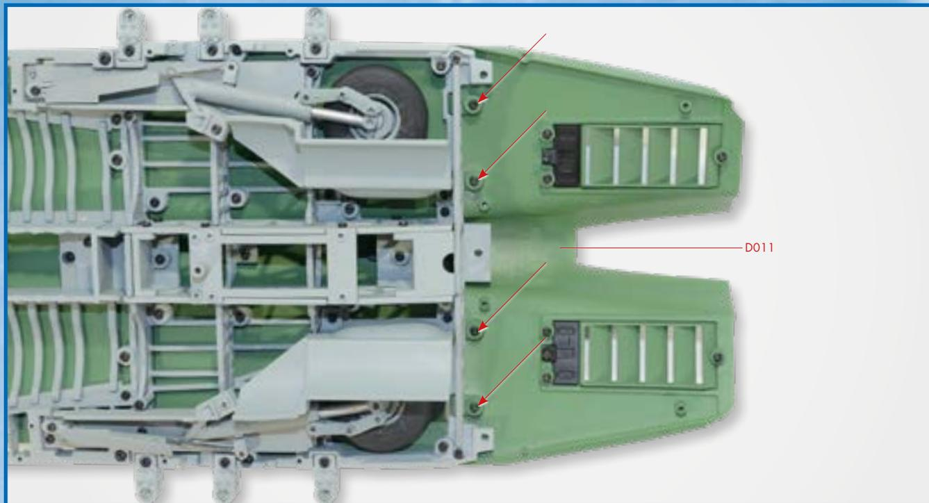
**1** Чтобы установить силовую раму средней секции фюзеляжа, вам потребуется осторожно вывернуть четыре винта, отмеченные на снимке красными стрелками, и отсоединить элемент верхней части средней секции фюзеляжа (D011). Винты и деталь D011 необходимо сохранить для дальнейшей сборки модели. Для этого можно использовать контейнер с крышкой или любую другую емкость.
